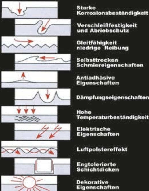
MULTIFUNKTIONALE BESCHICHTUNGEN® für Aluminium Legierungen, Stahl und Gußeisen, VA-Material und Buntmetall BIETEN GLEICHZEITIG und NACH MAß !!! Schutz gegen Korrosion, Verschleiß und Abrieb. Sie haben antiadhäsive, gleit und selbstschmierende Eigenschaften.
