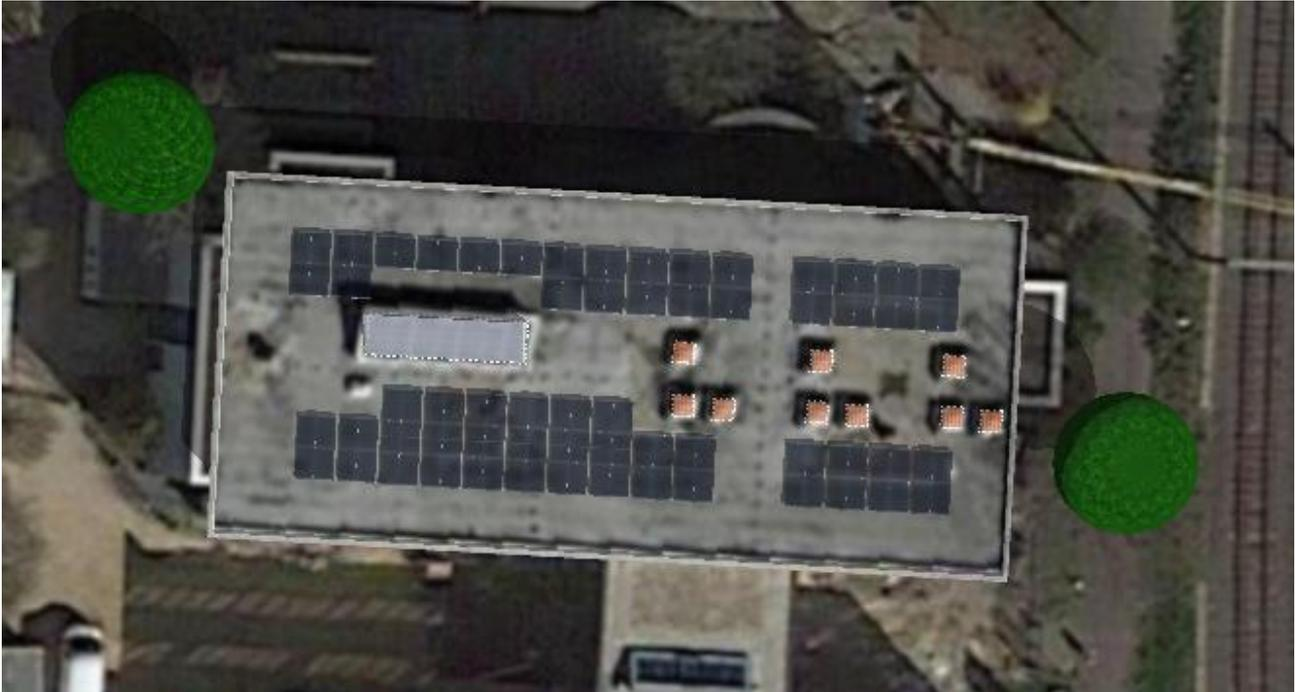
Abbildung 8: PV-Anlage – genordete Draufsicht Variante „maximal installierte Leistung“ (PVsol\*premium)
