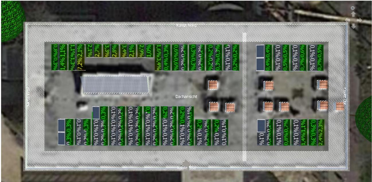
Abbildung 6: Verschattungsanalyse der Variante „maximal installierte Leistung“
